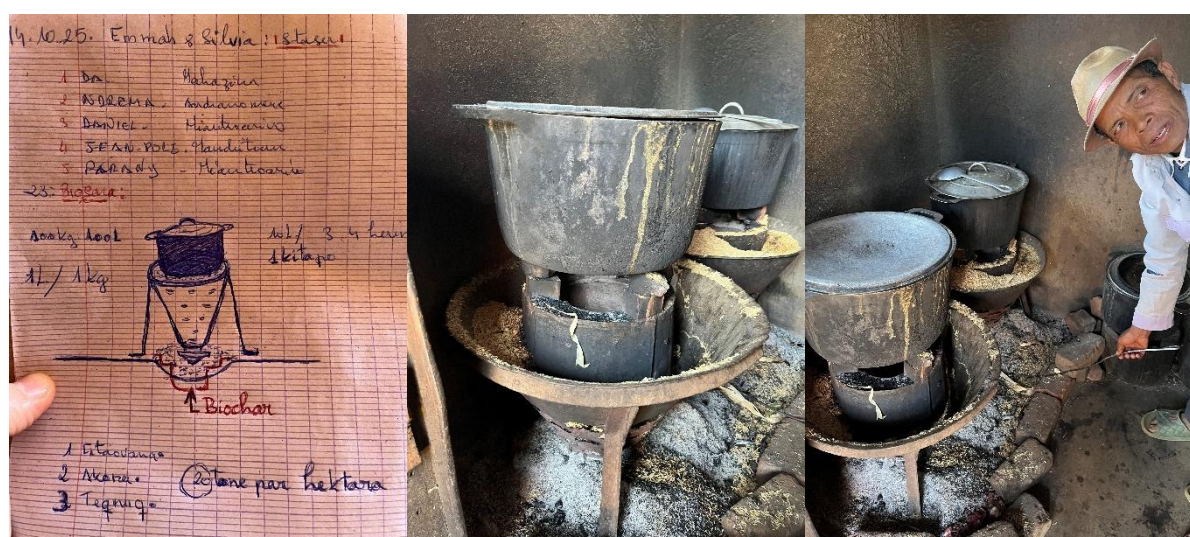
Figure 13 : Plan et four de cuisson à balles de riz (Source : auteure, 2025)
