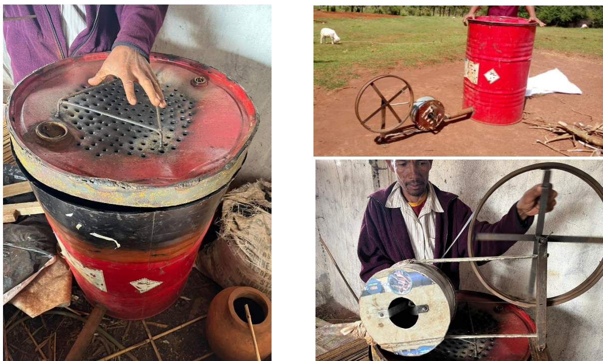
Figure 23 : Modèle de pyrolyseur TLUD avec ventilateur manuel (Source : auteure, Sylvia Laurencien, 2025)
