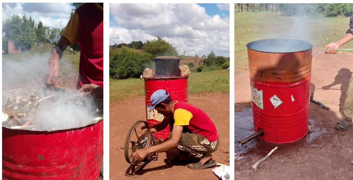
Figure 24 : Pyrolyse et refroidissement (Source : Sylvia Laurencien, 2025)
