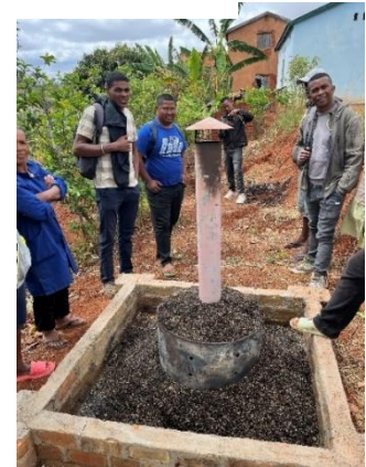
Figure 7 : Pyrolyseur avec enceinte de briques, Analamanga (Source : auteure, Analamanga, 2025)
