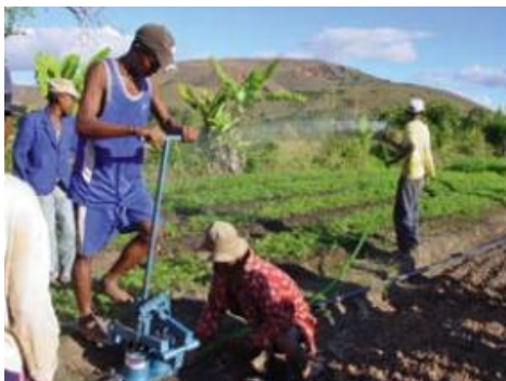
Figure 10: pompe à pédale, Source : FAO, 2014
