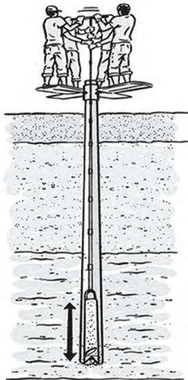
Le forage est un ouvrage creux, vertical et de petit diamètre servant à capturer l'eau souterraine.
