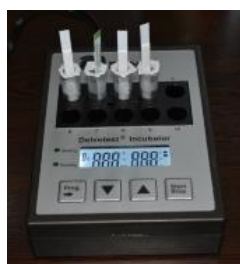
Contrôle qualité réalisé par le GBDC : détection des résidus d'antibiotiques par Deltotest, détection des mammites par test CMT
