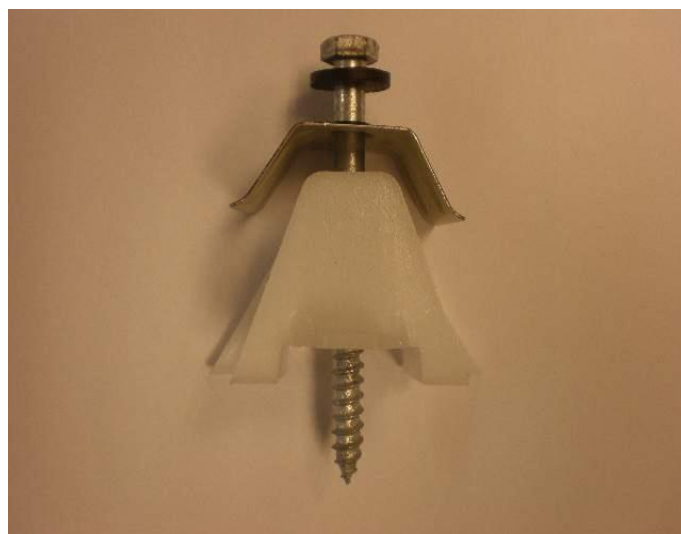
Photo H6: tirefond + joint caoutchouc + cavalier + cale d'onde
